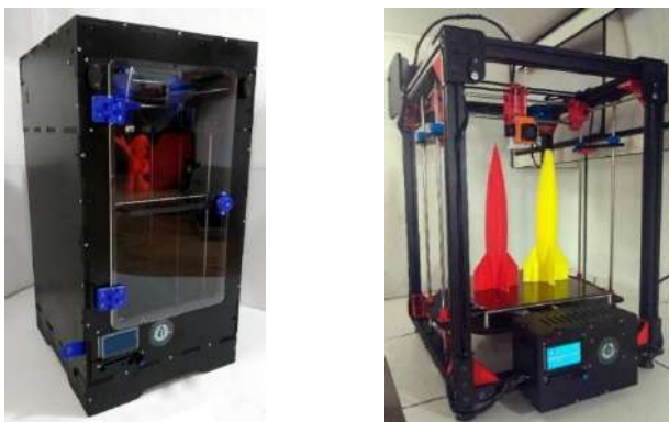
Figura 32. Prototipos desarrollados con cinemática Core XY “DAPINDUSTRIAL” y “DAPMINIMONSTER” [Fuente propia].
