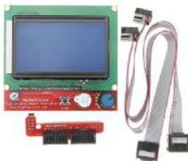
Figura 43. HMI a) LCD 128x64 b) Pantalla táctil a color [66]
