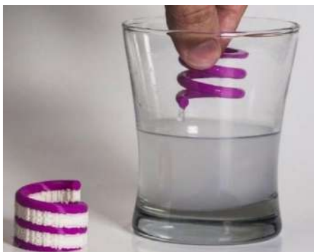
Figura 7. Representación del funcionamiento de soportes solubles para sistemas FDM
