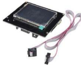
Figura 43. HMI a) LCD 128x64 b) Pantalla táctil a color [66]
