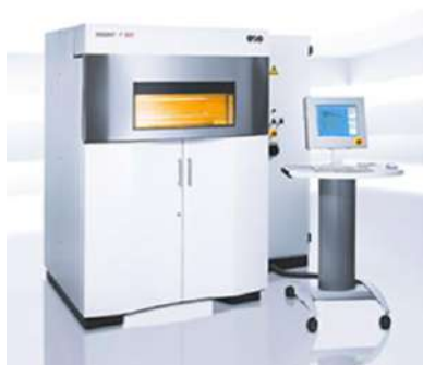
Figura 5. EOSINT 380 con sistema SLS, para la fabricación de partes metálicas
