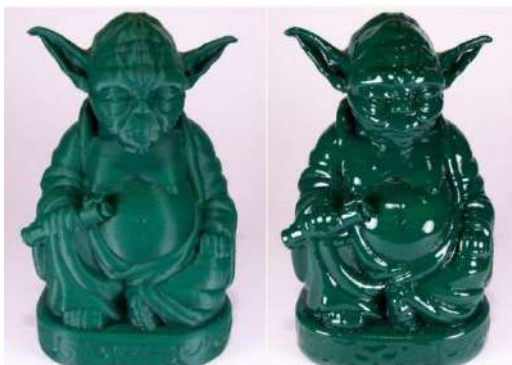
Figura 9. Proceso de terminación superficiales para piezas impresas en FDM [13]
