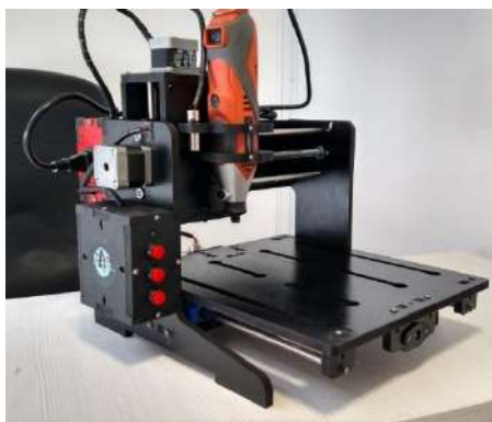
Figura 30. Primer prototipo creado CNC Router [Fuente propia]
