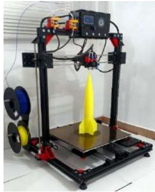
Figura 31. Primer prototipo creado de impresora FDM "DAPMONSTER" [Fuente propia].
